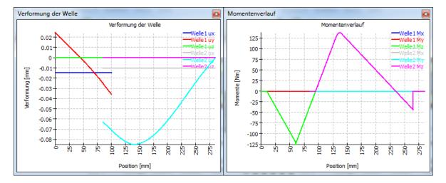
In diesen Diagrammen ist ein Sprung bei der Durchbiegung in y-Richtung zwischen den Wellen zu sehen. Dies ergibt sich aus der Lagersteifigkeit des Pilotlagers. Das Pilotlager ist an Position 95, es überträgt also nahezu kein Biegemoment.
