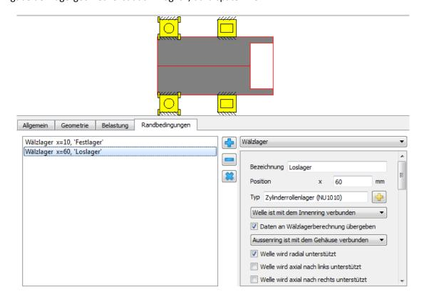
Da setzt eine Welle statisch bestimmt gelagert ist, können wie eine Berechnung mit dem 'fx'-Button in der Toolbar durchführen. Es sollte keine Fehlermeldung angezeigt werden.
